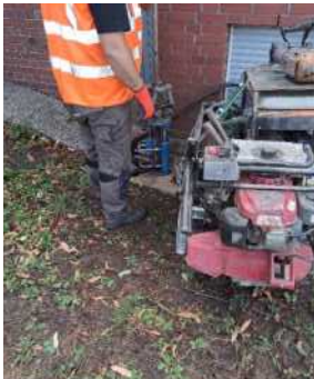
Entnahme der Bodenprobe: Die Sonde wird lotrecht in den Boden gerammt.
