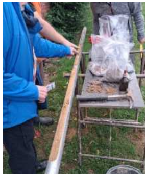
Die nun gezogene Sonde mit Bodenaufbau der verschiedenen Schichten
